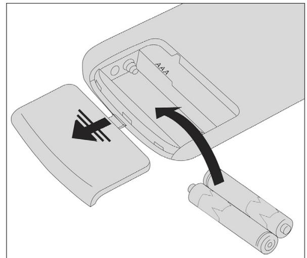
**IF THE REMOTE CONTROL IS SWITCHED OFF DUE TO NO BATTERY INSTALLED, THE STOVE CAN BE CONTROLLED FROM THE COMMAND PANEL LOCATED ON THE UPPER PART OF THE STOVE. WHEN CHANGING THE BATTERIES, MAKE SURE YOU FOLLOW THE SYMBOLS PRINTED INSIDE THE REMOTE CONTROL.**
