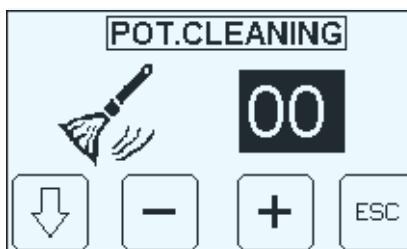
Izbornik omogućuje povećavanje učestalosti automatskog čišćenja ložišta. (Opseg 0-50%)
