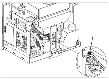
Fig. 19 - ELECTRICAL CONNECTION
