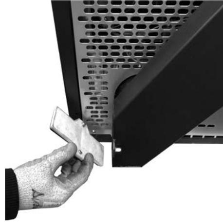
Fig. 57 - Fume conduit cleaning
