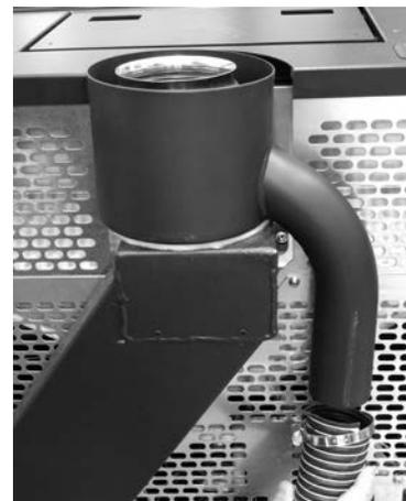
**Fig. 40 - 2-inlet connection**
