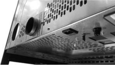
Fig. 41 - Frame<sup>3</sup> cap removal
