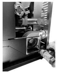
Fig. 62 - Remove fan screws
