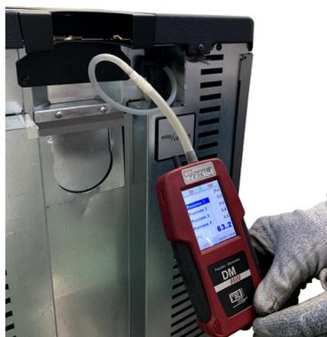
**Fig. 89 - Collegamento pressostato digitale (Atena<sup>3</sup> Plus12/14 - Duke 12/14 At - Saba 12/14)**
