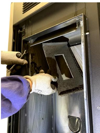
**Fig. 99 - Rimuovere la testa del focolare 2**
