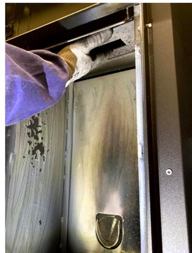
**Fig. 98 - Rimuovere la testa del focolare 1**
