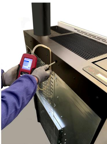
Fig. 90 - Collegamento pressostato digitale (Mithos<sup>3</sup> Plus12/14)
