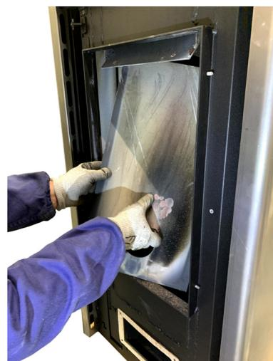
**Fig. 101 - Rimuovere la schiena del focolare**
