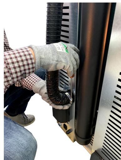
Fig. 56 - Innestare tubo dell'aria comburente
