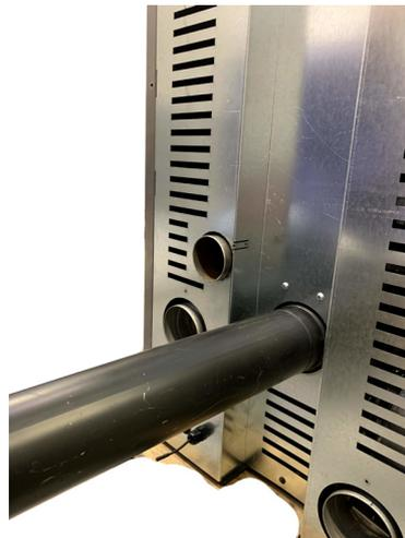
**Fig. 47 - Collagare il tubo di scarico**
