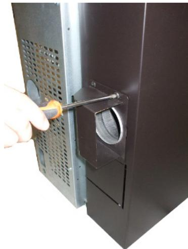
*Fig. 86 - Montaggio diffusore*
