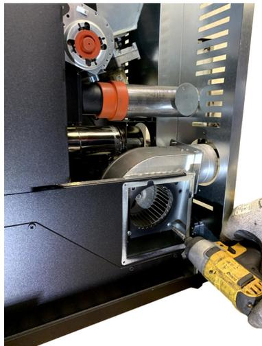
**Fig. 62 - Rimuovere viti ventilatore**
