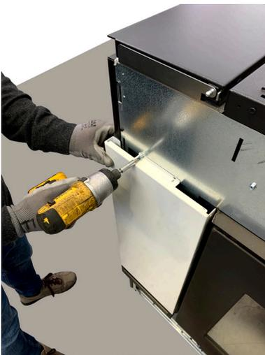
*Fig. 36 - Fissare pannelli laterali*
