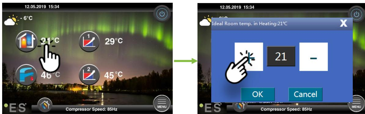
Ha a feljönő ablak **az Ideális helyiséghőmérsékletet mutatja**. a **fűtéskor** a helyiség érzékelője be van szerelve, és a hőszivattyú kis módosításokat végez a fűtési görbén, hogy megtartsa a kívánt szobahőmérsékletet.
