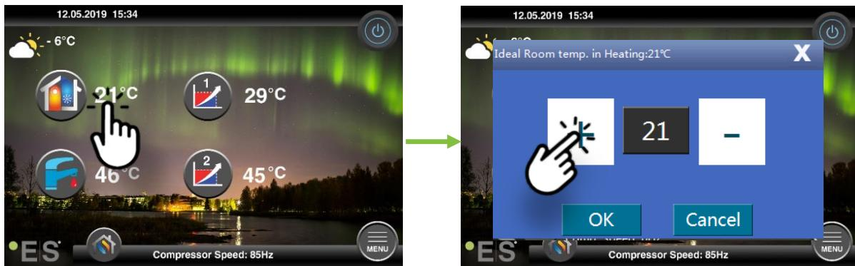
Pokud okno, které se objeví, zobrazuje **ideální teplotu místnosti**. Při vytápení je instalován senzor místnosti a tepelné čerpadlo provede malé úpravy křivky vytápení, aby se udržela požadovaná pokojová teplota.
