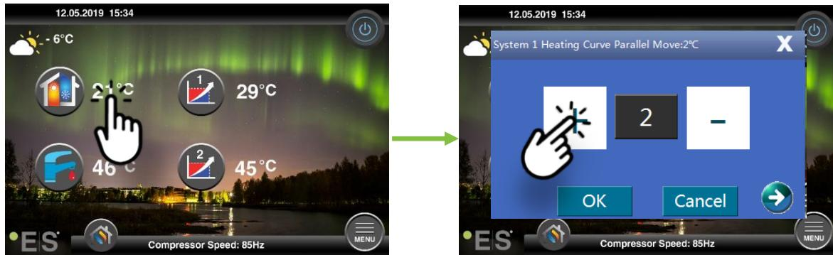
Ako prozor koji se pojavljuje prikazuje **Para krive za grejanje sistema 1...** senzor sobe nije instaliran ili aktiviran. Sobna temperatura se zatim kontroliše u skladu sa krivom topotom.
