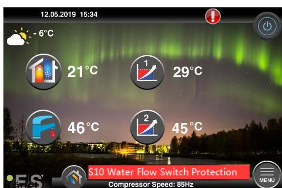
1 Yksi vika, joka voi ilmetä, on S10, mikä tarkoittaa, että vesi virtaa lämpöpumpun läpi liian alhaiseksi turvalliseen ja ongelmattomaan käyttöön. Voi olla useita syitä, miksi virtaus ei riitä, yleisin on, että suodattimet on puhdistettava tai kaikki termostaattit on suljettava. Varmista, että suodattimet eivät ole tukossa, ja varmista, että vähintään 3 termostaattia on täysin auki (lämmitysjärjestelmän tyypistä riippumatta).
