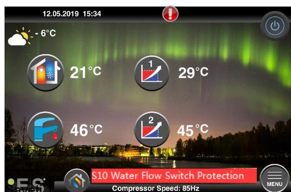
Jedan kvar koji može da se javi je **S10**, što znači da je protok vode kroz topotnu pumpu prenizak za bezbedan i bez problema. Možda postoji nekoliko razloga zbog kojih protok nije dovoljan, najčešći je taj što filteri treba da se očiste ili da se svi termostati zatvore. Uverite se da filteri nisu zapušeni i uverite se da su najmanje 3 termostata potpuno otvorena (bez obzira na vrstu sistema grejanja).
