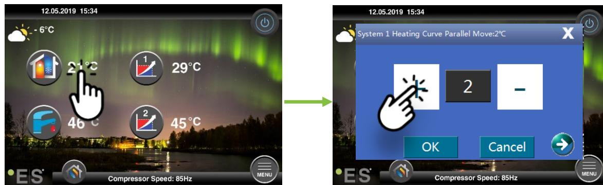
Ja parādītajā logā redzama **1. sistēmas sildīšanas līknes rindkopa**... istabas sensors nav uzstādīts vai aktivizēts. Pēc tam istabas temperatūru kontrolē saskaņā ar siltumalīkni .
