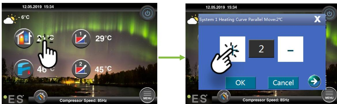
Wenn das angezeigte Fenster **System 1 Heizkurve para...** der Raumsensor ist nicht installiert oder aktiviert. Die Raumtemperatur wird dann entsprechend der Wärmekurve gesteuert.
