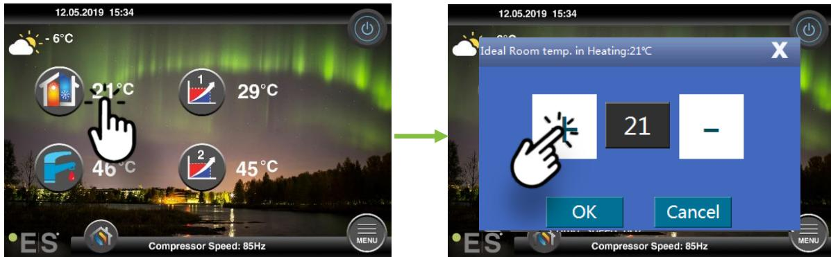
Wenn das Fenster, das auftaucht, **ideale Raumtemperatur zeigt**. Bei der Heizung wird der Raumsensor installiert und die Wärmepumpe nimmt kleine Anpassungen an der Heizkurve vor, um die gewünschte Raumtemperatur zu halten.
