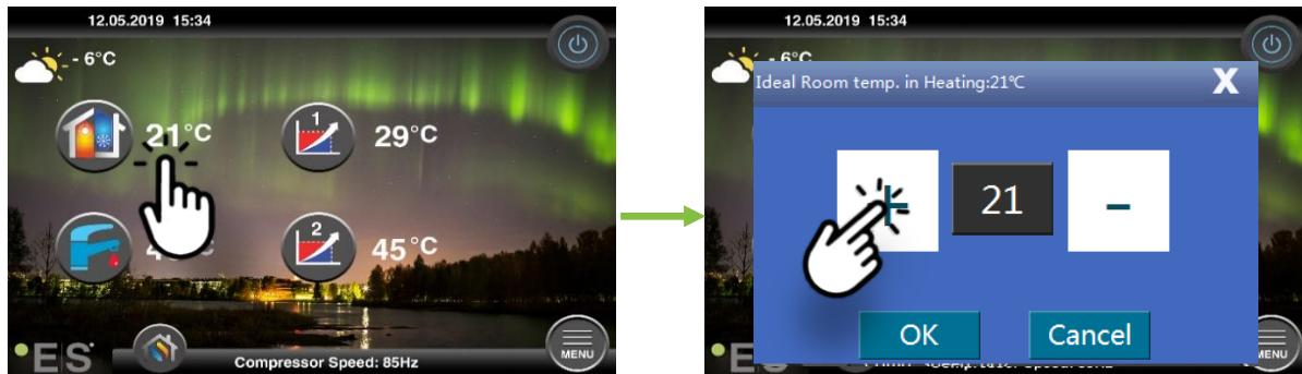
Als het raam dat naar boven komt **ideal room temp.** laat zien bij het verwarmen wordt de ruimtesensor geïnstalleerd en maakt de warmtepomp kleine aanpassingen aan de verwarmingscurve om de gewenste kamertemperatuur te behouden.
