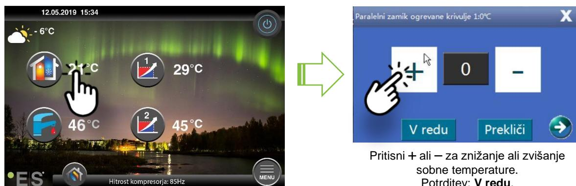
V kolikor se v novem prikazanem oknu pojavi napis **Paralelni zamik ogrevane krivulje** sobni temperaturni senzor ni inštaliran ali pa aktiviran. Sobna temperatura se tako uravnava po ogrevalni krivulji.
