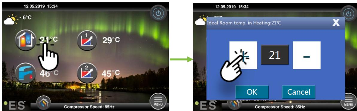
Jeśli pojawi się okno, pokaże idealną temperaturę pokojową. Podczas ogrzewania czujnik pokojowy jest zainstalowany, a pompa ciepła dokonuje niewielkich korekt krzywej grzewczej, aby utrzymać żądaną temperaturę pokojową.
