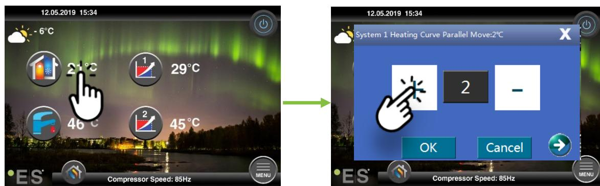
Jeśli okno, które się pojawi, pokazuje krzywą grzewczą Systemu 1 dla ... czujnik pokojowy nie jest zainstalowany lub aktywowany. Temperatura w pomieszczeniu jest następnie kontrolowana zgodnie z krzywą grzewczą.
