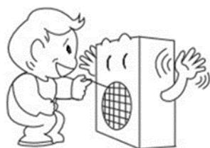
Rør ikke ved ventilatordækslet, når ventilatormotoren kører
