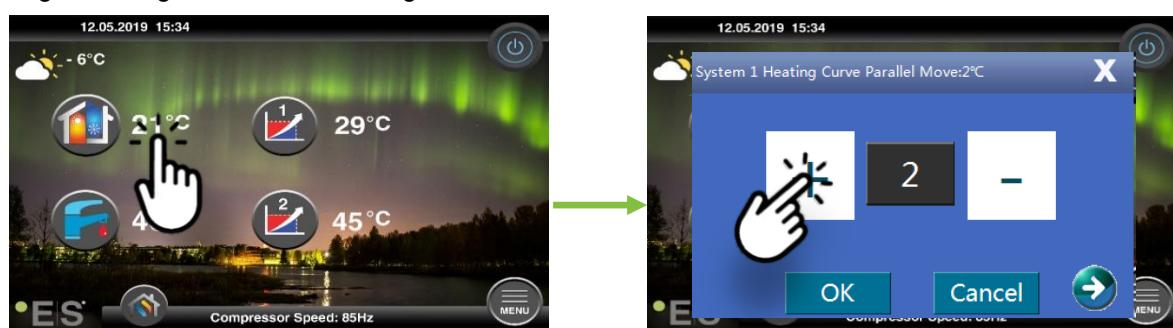
Als het venster dat verschijnt **systeem 1 verwarmingscurve para...** de ruimtesensor is niet geïnstalleerd of geactiveerd. Dekamertemperatuur wordt dan geregeld volgens de warmtecurve.
