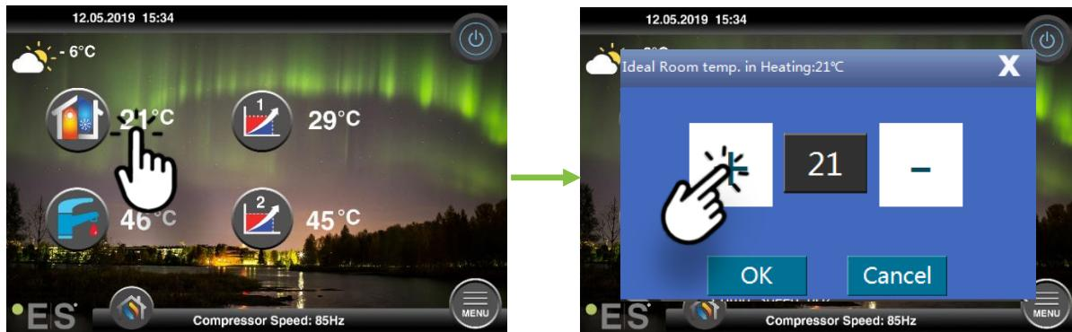
Ja logs, kas parādās, parāda ideālu telpas **tempu**. Apsildē tiek uzstādīts telpas sensors un siltumsūknis veic nelielus pielāgojumus apkures līknē, lai saglabātu vēlamo istabas temperatūru.
