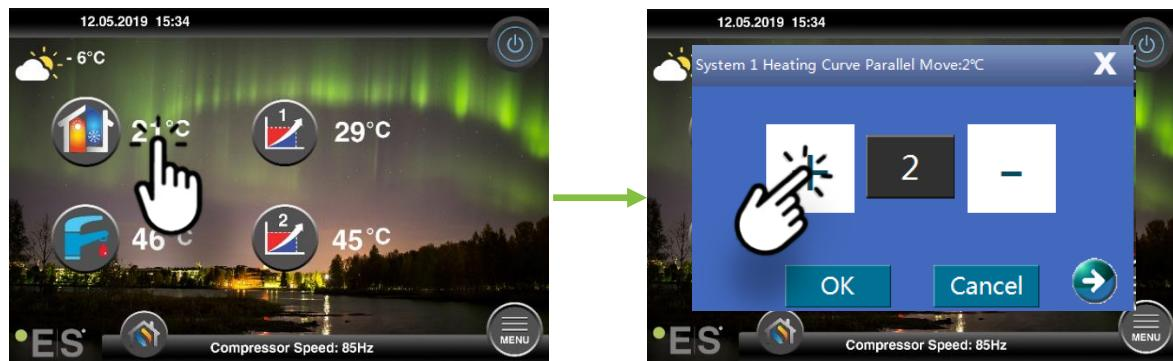
Daca in fereastra de dialog regasim titlul “**Sistem 1 Curba incalzire cu miscare paralela...**” – sau “**System 1 heating curve parallel Move**” – in acest caz, nu exista senzor de temperatura ambientala, iar temperatura din camera va fi controlata in functie de curba de incalzire
